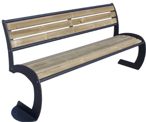
Panchina metallo-legno costituita da due robuste spalle laterali in acciaio sp.8 mm tagliate con tecnologia laser piegate con presso-piega nella parte inferiore a formare le basi di forma semicircolare predisposte per poter fissare la panchina al suolo con tasselli ad espansione.
